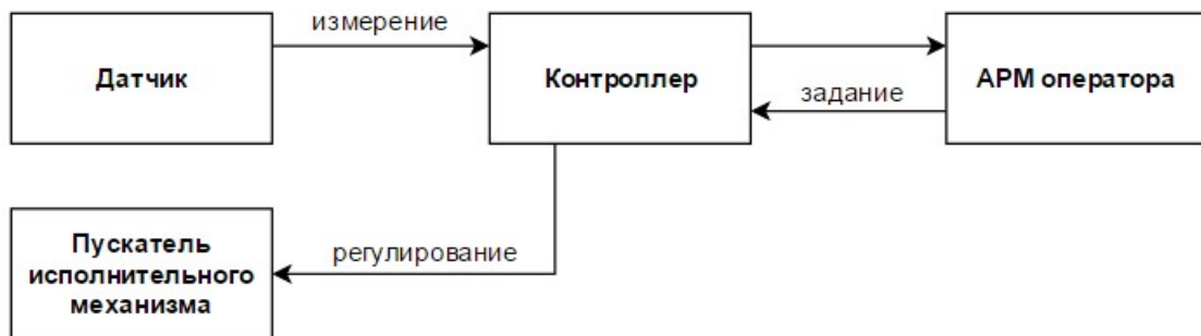
Рисунок 2: Схема прохождения сигналов в процессе автоматического и ручного управления
