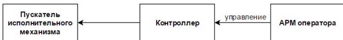
Рисунок 3: Схема управления дискретным сигналом
