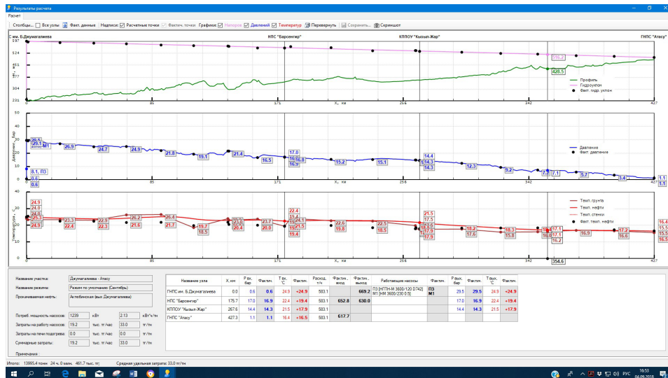
Рисунок 3: Сравнение расчетных (линии) и фактических (точки) данных в нефтепроводе Джумагалиева – Атыу
