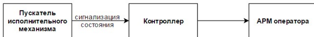
Рисунок 4: Схема прохождения сигналов при сигнализации состояния
